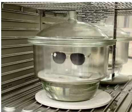
图6 镜架要求(抗汗腐蚀)测试
