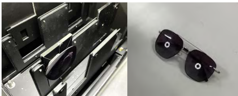
图 3 紫外光谱范围透射比测试
